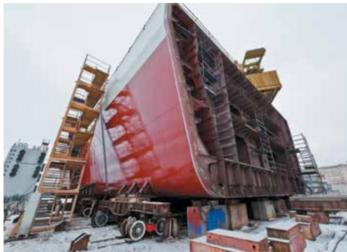
Строительство судна на Выборгского судостроительном заводе
